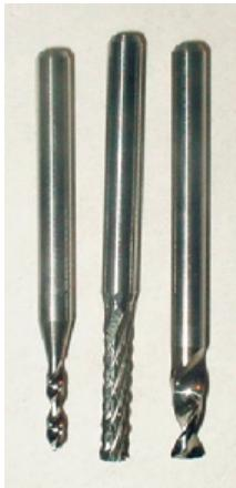
切削工具はこのような形をしています。電動ドリルの先につける刃に似ていますが、尖端が斜めに尖らず、角張ったもの、丸いものなどがあります。
