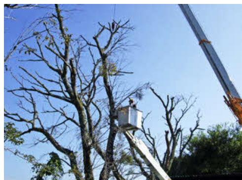
高所作業車を使った特殊伐採 ※写真：阿蘇森林組合提供
